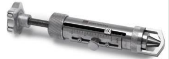
Gambar 11. Alat uji ukur kekerasan tablet manual.
