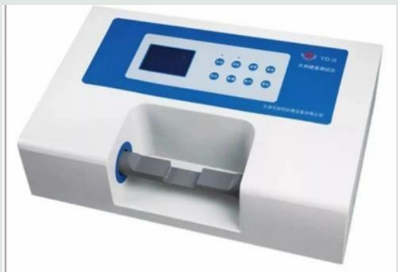
Gambar 11. Alat uji ukur kekerasan tablet manual.
