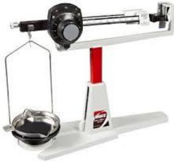
Alat ini digunakan untuk menimbang bahan dengan ketelitian alat sedang (0.01-0.001 gram). Selain itu digunakan pula untuk menimbang bahan kimia dalam proses pembuatan larutan, akan tetapi bukan yang digunakan untuk standarisasi.
