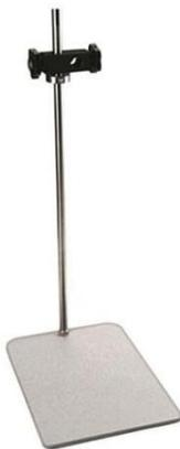
Papan dan batang besi digunakan untuk penahan rangkaian alat-alat.
