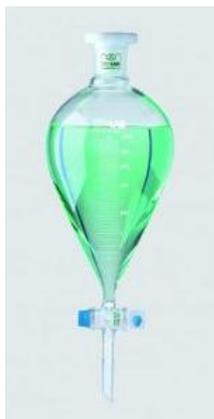
Berupa corong yang bagian atasnya bulat dengan lubang pengisi terletak di sebelah atas, bagian bawahnya berkatup. Terbuat dari kaca.
