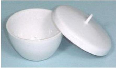
Alat ini digunakan sebagai wadah sampel dalam proses pengabuan. terbuat dari porselen atau logam inert.
