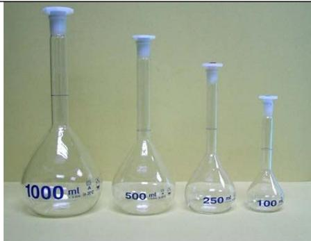
**Kegunaan:** Merupakan alat pengukur volume yang teliti. Untuk membuat larutan dengan konsentrasi tertentu dan mengencerkan larutan dengan keakurasian yang tinggi.
