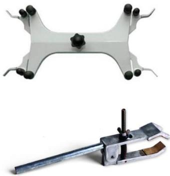
Batang penjepit terbuat dari besi. Digunakan untuk menahan alat-alat secara vertikal.
