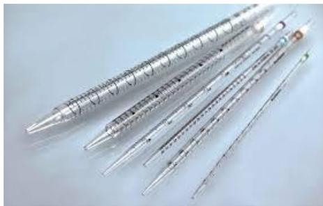
Pipet ukur memiliki skala. Digunakan untuk mengambil larutan dengan volume tertentu. Gunakan bulb atau pipet pump untuk menyedot larutan, jangan dihisap dengan mulut.
