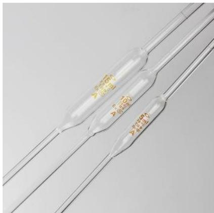
Pipet ada dua macam : yang satu untuk mengambil sejumlah volume (**a. pipet volumetrik**).
