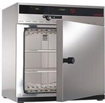
Alat ini digunakan sebagai tempat fermentasi dengan suhu dan kelembaban terkendali, serta digunakan untuk menumbuhkan media pada pengujian secara mikrobiologis. Pada alat ini biasanya sudah dilengkapi dengan alat pengukur kelembaban.
