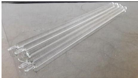
Batang gelas, dengan ujung bulat atau ujung pipih. Panjang 15 cm.
