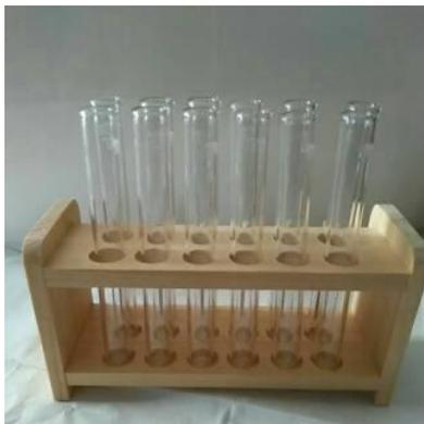
Berupa tabung yang kadang dilengkapi dengan tutup. Terbuat dari kaca borosilikat tahan panas, terdiri dari berbagai ukuran tabung reaksi.
