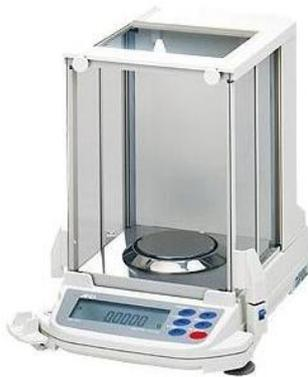
Alat ini berfungsi untuk menimbang bahan dengan ketelitian tinggi (0.0001 gram). Serta digunakan untuk menimbang bahan kimia dalam proses pembuatan larutan untuk uji kuantitatif dan proses standarisasi. Selain itu berfungsi untuk menimbang sampel / bahan dalam analisis kuantitatif. Neraca analitik jenis ini yang sering digunakan di laboratorium kimia.
