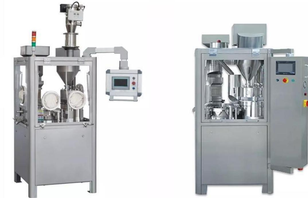
**Mesin pengisi kapsul semi otomatis dan fully automatic**
