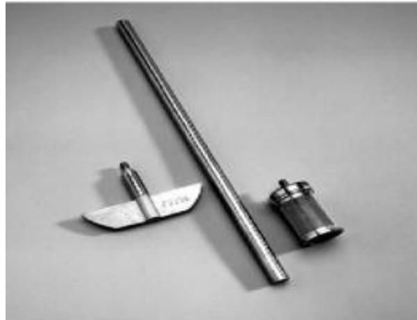
**Alat untuk mengukur kecepatan kelarutan (dissolution)**
